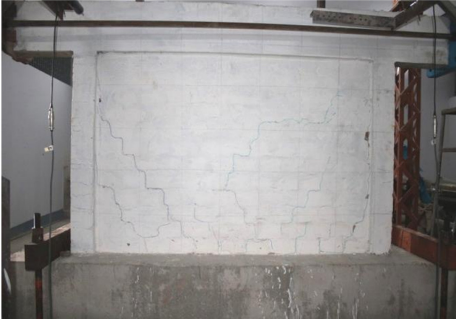
Figure 3. Pola Retakan Setelah Dua Siklus Pergeseran Drift sebesar 0,05%
